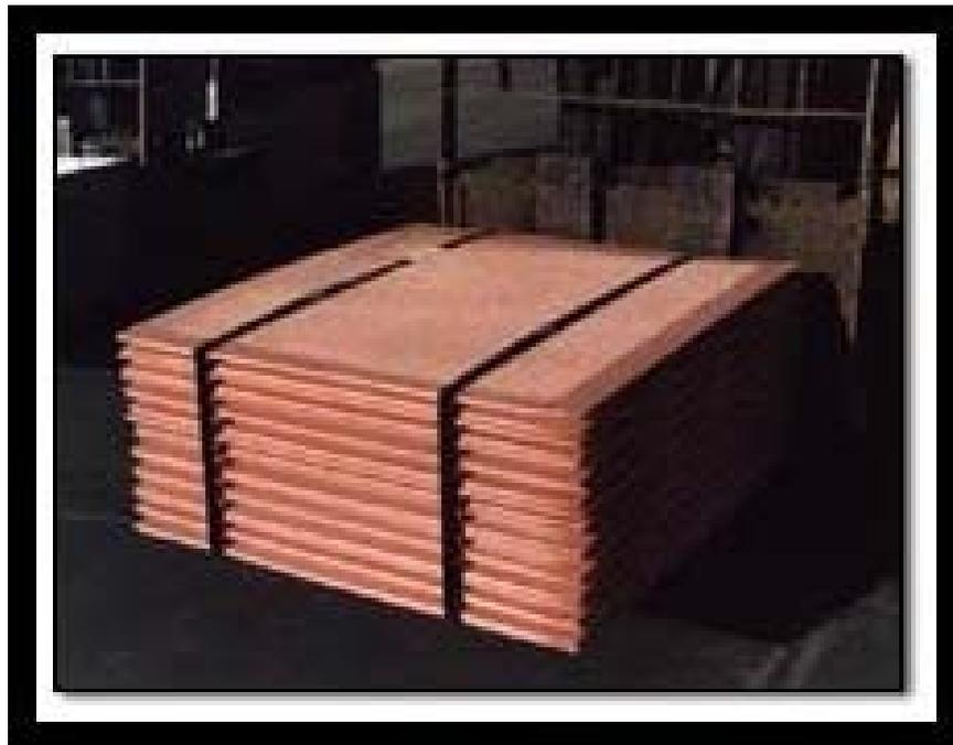
**Figura 8:** Cátodos de cobre electroobtenidos
