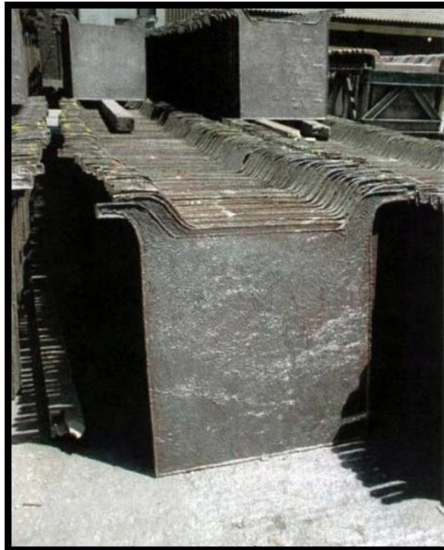
**Figura 2:** Ánodos de cobre impuro.
